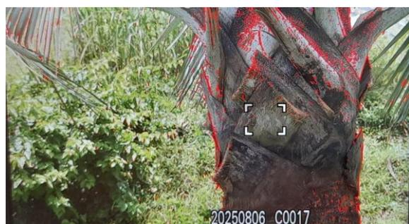
La cámara enfoca al objeto que estén en el punto designado. El punto se puede mover usando el joystick, sin necesidad de cambiar el encuadre
