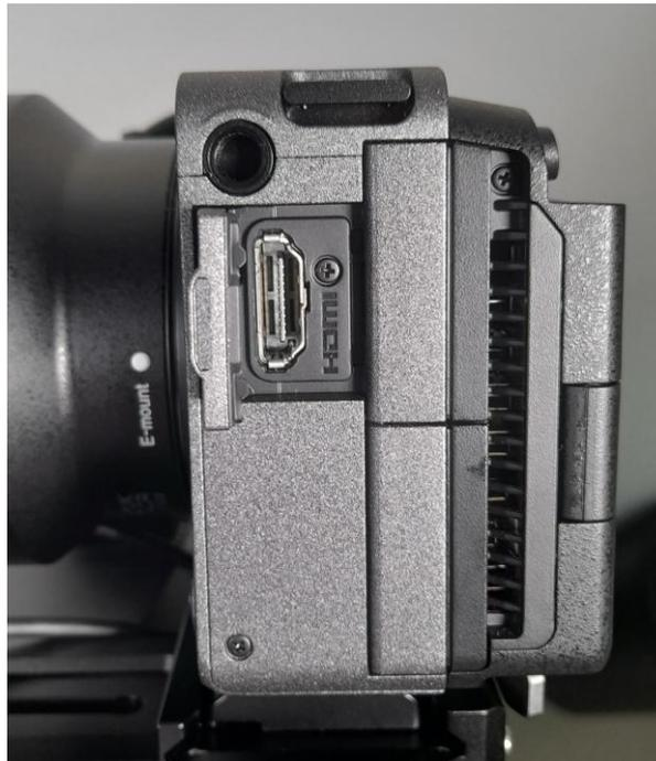
El cable que se incluye con el monitor es de HDMI a mini HDMI. Sin embargo, la Sony FX30 tiene salida de HDMI, por lo que se necesita un cable HDMI que sea de tamaño normal por ambos lados.
