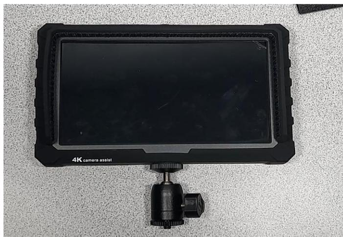
Con el monitor, se incluye una pieza que funciona para montarlo a la cámara. Tiene dos lados, el de color plateado es un tornillo que se enrosca en el monitor, ya sea en la parte de arriba o de abajo. El otro lado es el que se coloca en la cámara. Se puede acoplar de dos maneras.
