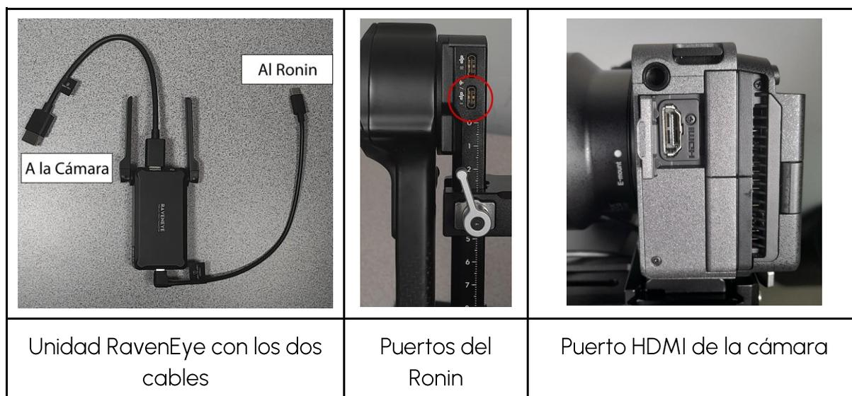
El Raven Eye se monta en el Ronin por debajo de donde va colocada la cámara. Hay una abertura donde se debe colocar y deslizar con fuerza. Se recomienda conectar los cables de manera de que no queden sueltos
